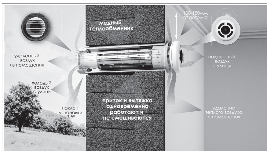
Рис.1. Принцип работы рекуператора PRANA-150, PRANA-200С, PRANA-200G
